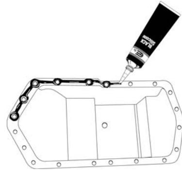
**NOTA:** NO recomendado usar en partes continuamente sumergidas en gasolina. NO USAR junta instantánea solamente cuando reemplazando juntas cabezales. La junta cabezal es necesaria debido a la temperatura muy alta y la presión.
